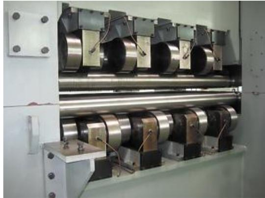
Станок выравнивания прокатанного листового материала производства компании, применяется главным образом для выравнивания листового материала, разных видов вырубленных в виде заготовки. Станок является высокотехнологичным оборудованием, имеет высокую точность, широкую область применения высокую степень автоматизации, отличается высокой надежностью и высокой производительностью при работе по выравниванию всех видов холоднокатаного листа.
