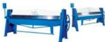
Листогибы с сегментной балкой серии WF предназначены для сгиба профилей коробчатого типа с дополнительными боковыми гибоми. Быстрая фиксация и освобождение заготовки осуществляется с помощью пердали и возвратных пружин.
